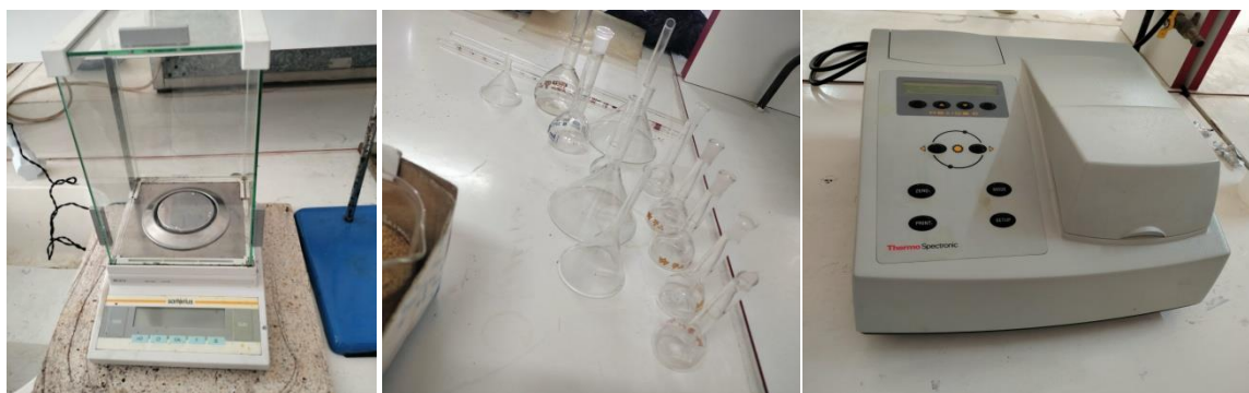
Figure N°15 : Matériels utilisés pour la détermination du taux de polyphénols totaux du distillat (original 2022).
