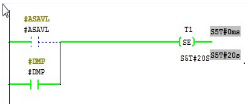
Figure-20 : visualisation dans le programme l'état du moteur M1
