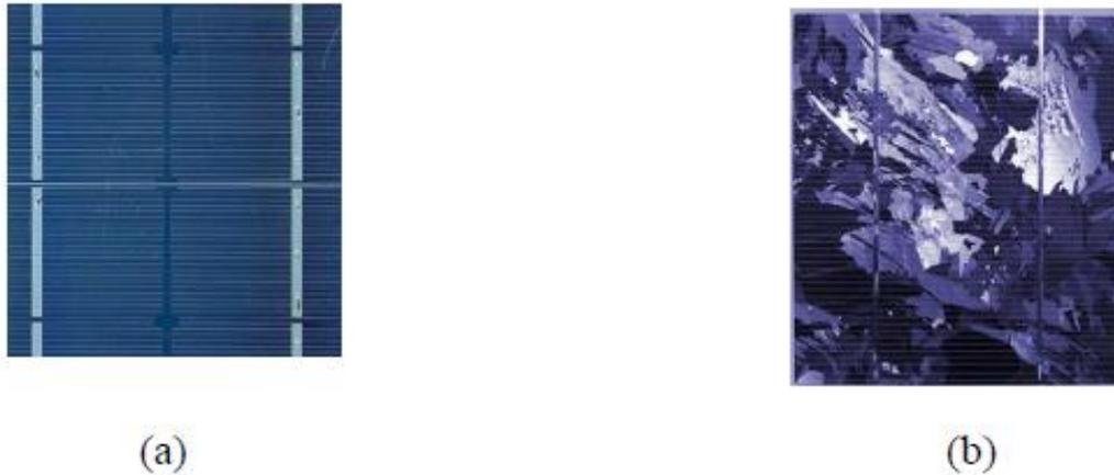
**Figure I.7 :** Photos de cellules monocristallin(a) et multicristallin (b).
