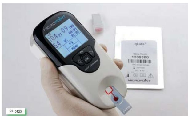
**Figure 6:**Dispositif d'automesure de l'INR[91]
