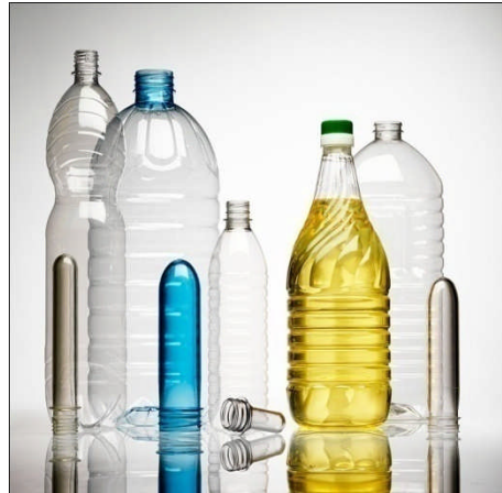
Figure II-5 : Pièces obtenue par l'injection soufflage
