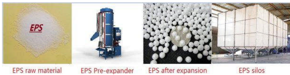
Figure II-14 : Etapes de fabrication des pièces en PSE.
