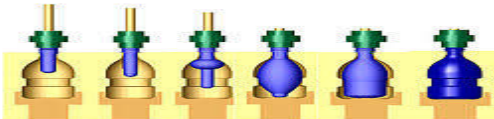
Figure II-6: Etapes de l'injection soufflage
