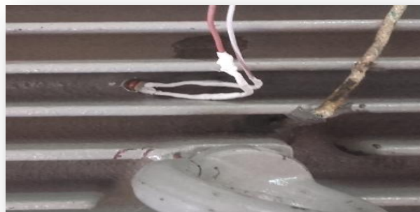
Fig IV.12 Emplacement du capteur sur la carcasse
