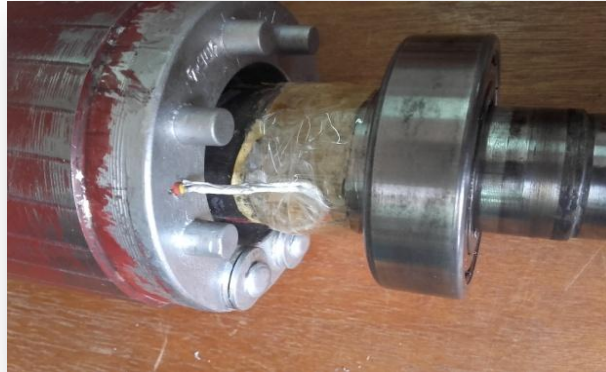
Fig IV.10 Image de l'emplacement du capteur du côté ventilé
