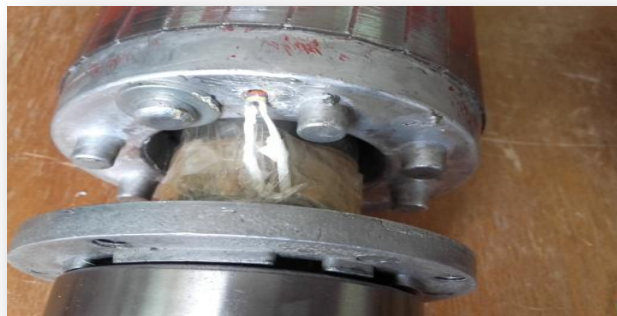
Fig IV.11 Image de l'emplacement du capteur du côté non ventilé
