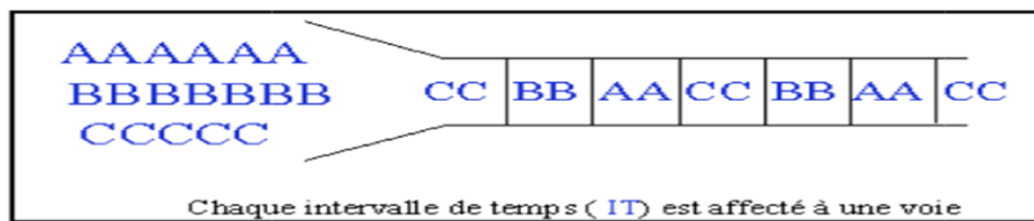
Figure 32 : Répartition des périodes dans le cas de multiplexage TDM [18].
