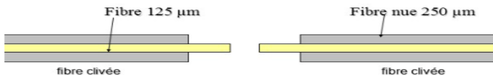
Figure 11 : Clivage des deux fibres avant de les placer sur le support [7].
