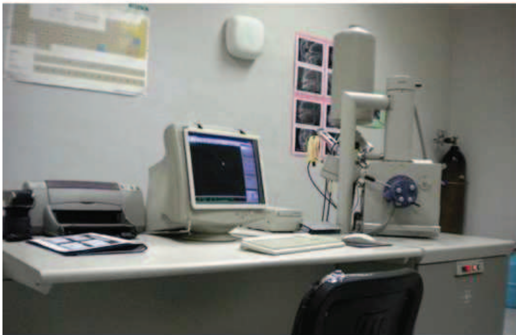
Figure(III.11) : Photographie du microscope électronique balayage ESEM XL 30 Philip.
