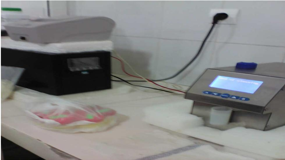
**Figure 12 : Appareil MILK LACTOSCAN**
