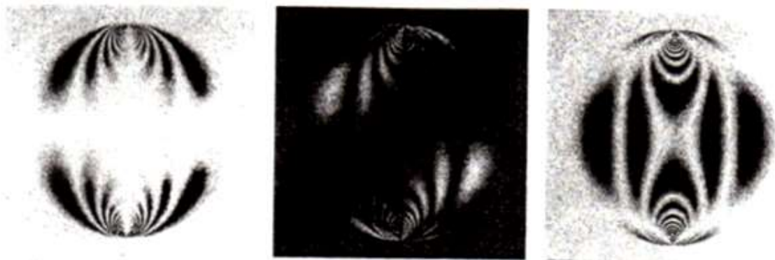
Polariscope rectiligne P //A Polariscope rectiligne P et A Polariscope circulaire P //A sont croisés
