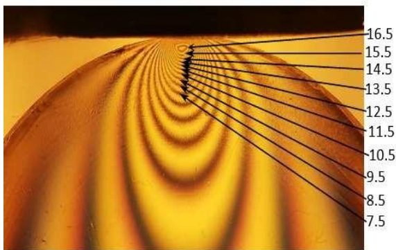
Figure IV - 15 : Réseau d'isochromes observé sur le polariscope pour la partie supérieure (modèle 2).
