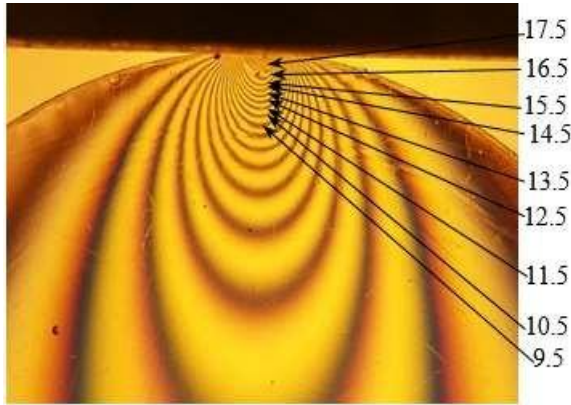
Figure IV - 11 : Réseau d'isochromes observé sur le polariscope pour la partie supérieure (modèle 1).
