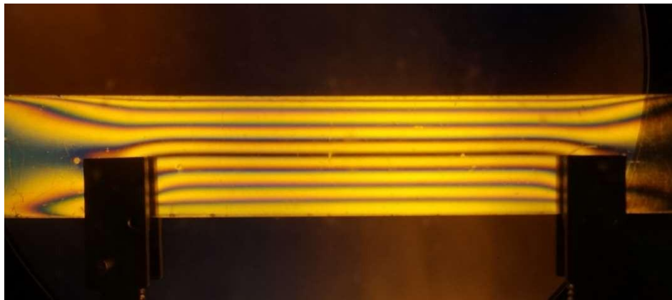
Figure IV - 8 : Les franges isochromes obtenues en flexion 4 points.
