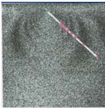
Figure I - 14 : Franges expérimentales obtenues pour une tranche de 10mm d'épaisseur située le long de la direction de la charge. [12]
