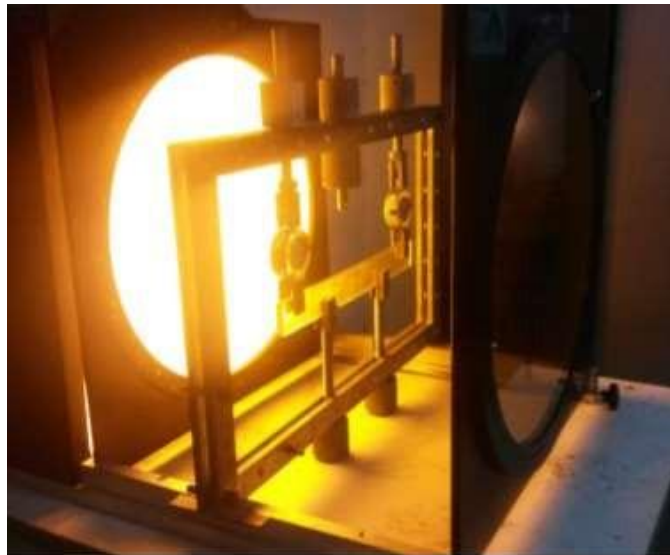
Figure IV - 6 : Observation du modèle utilisé placé sur le polariscope plan.
