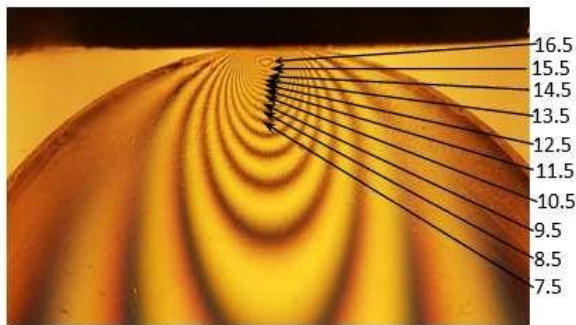
Figure IV - 19 : Réseau d'isochromes observé sur le polariscope pour la partie supérieure (modèle 3).
