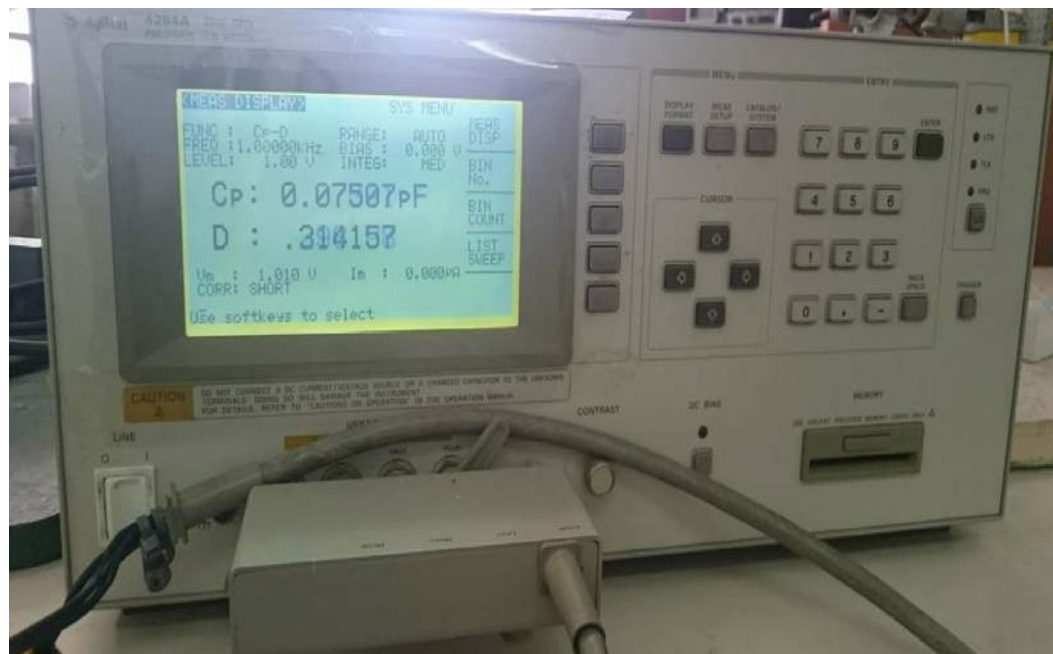
Figure II-3: Image de l'impédance -mètre
