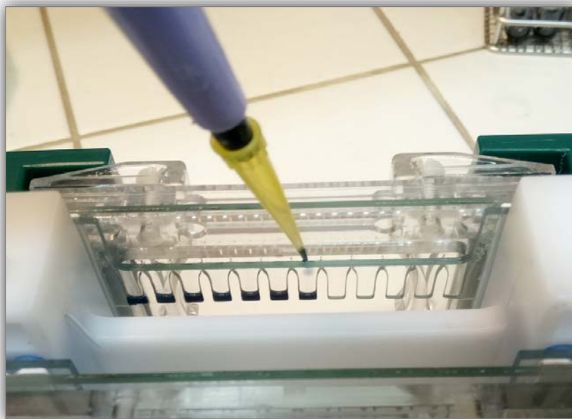
Figure 31. Photographie de l'opération d'injection de sérums précolorés dans les puits de dépôt.
