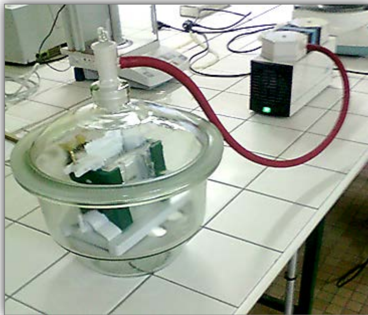
Figure 30. Photographie montrant le processus de polymérisation dans une cloche à vide. La cloche est introduite telle qu'elle au bain marie durant le processus de polymérisation.
