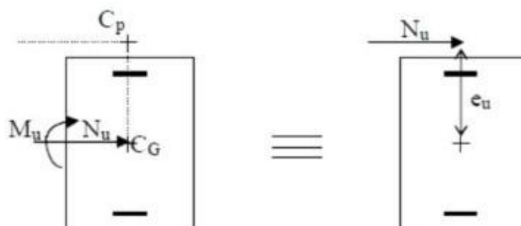
Figure III.1.5. Section rectangulaire soumise à la flexion composée
