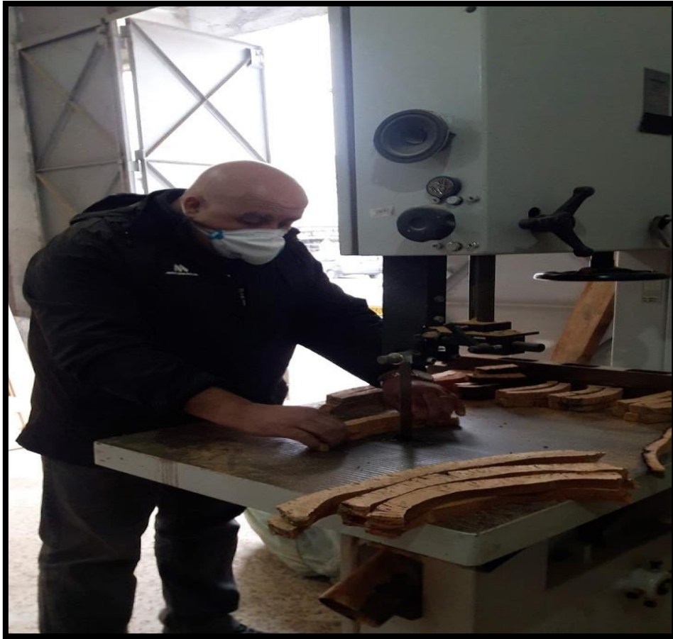
Annexe 13 : Façonnage des planches du liège au niveau de la menuiserie.
