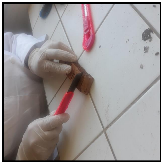
Annexe 14 : Le matériel utilisé pour réaliser les éprouvettes de la mesure de la porosité.
