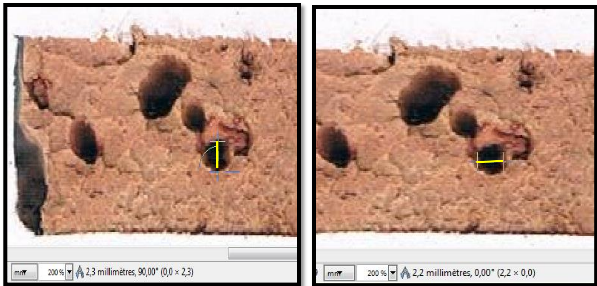
Figure 18 : Les éprouvettes utilisées pour la mesure de la porosité.
