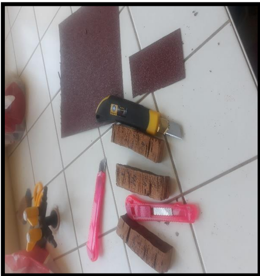
Annexe 14 : Le matériel utilisé pour réaliser les éprouvettes de la mesure de la porosité.
