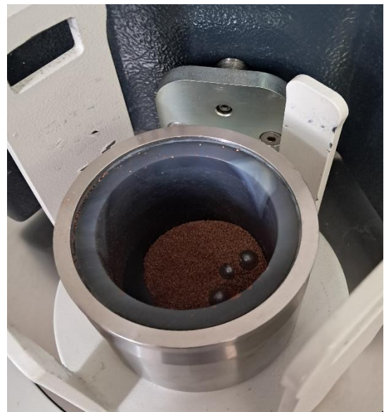
Figure IV.27 : jarre et billes du broyeur.
