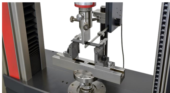
Figure II.28 : prototype de test de flexion en 3 points.
