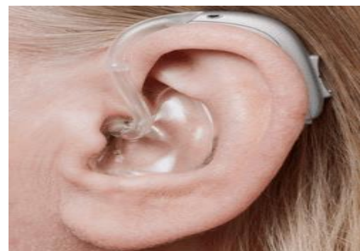
Figure II.13 : Coque externe d'un appareil auditif à base de résine acrylique.
