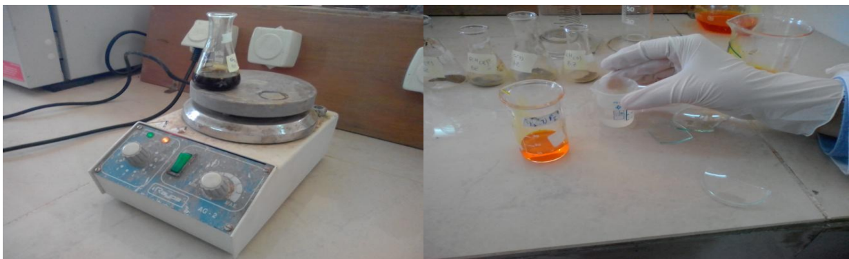
Figure 8 : Différentes étapes de détermination du taux de la matière organique dans le sol.
