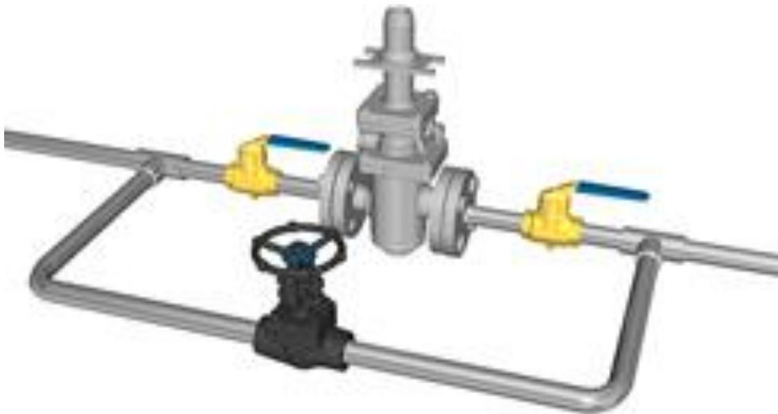
Figure III. 20 Vanne by-pass sur détendeur-régulateur de pression [19]
