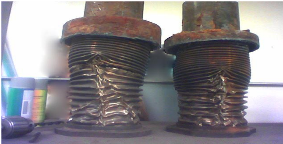
Figure I. 3 Joint de dilatation détruit par un coup de bélier [7]
