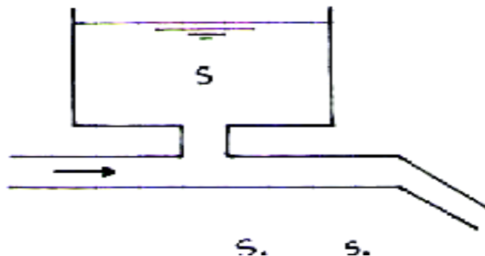
Figure III. 12 Cheminée à étranglement
