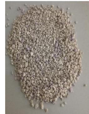
Figure III.2. Grains de sépiolites
