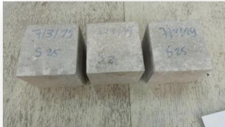
**Figure III.11** : échantillon de béton pour essai de compression
