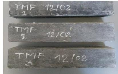
**Figure III.12** : échantillon de béton pour essai de flexion
