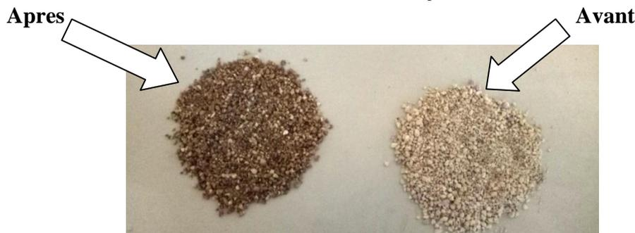
Figure III.10: Grains de sépiolite avant et après Imprégnation par le MCP
