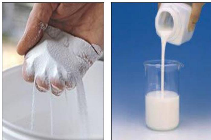
**Figure II.9 :** Exemple des MCP micro-encapsulés : à l'état poudre et à l'état liquide
