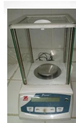
Figure III.7. Balance analytique
