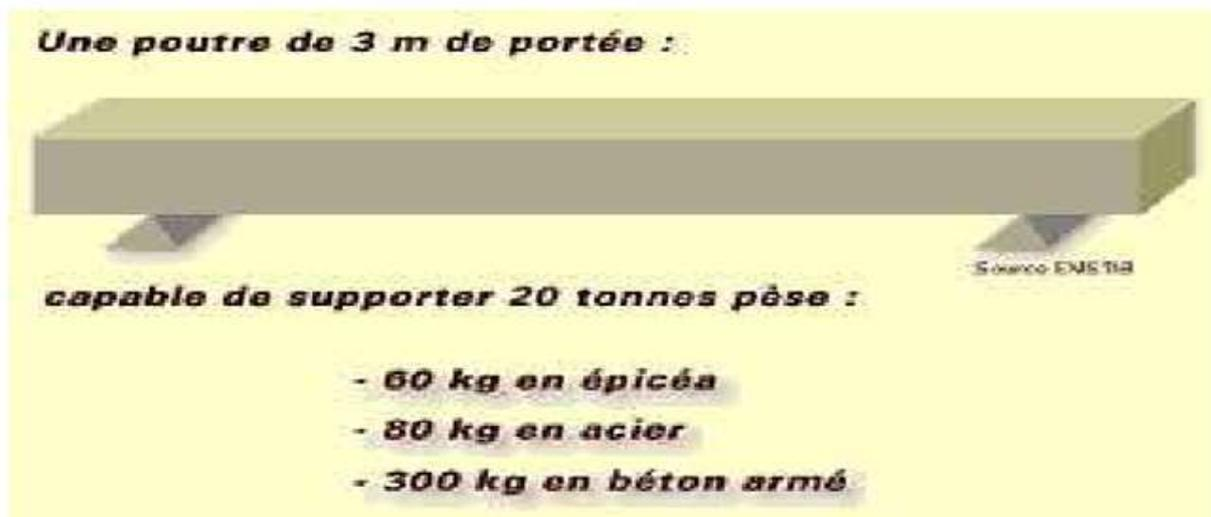
**Figure II.9-** Comparaison des matériaux bois, acier et béton armé
