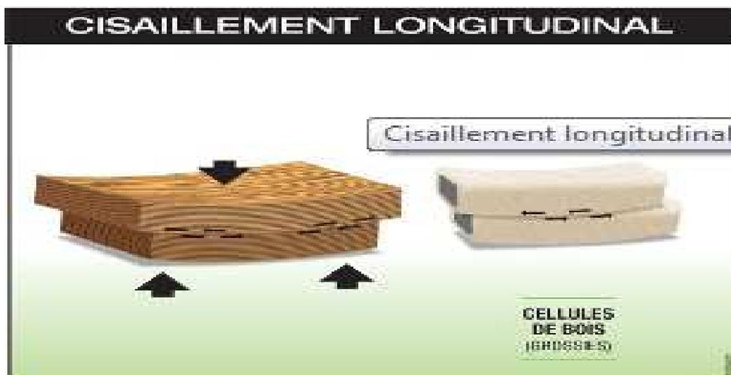
Figure II.21-Contrainte de rupture de cisaillement.
