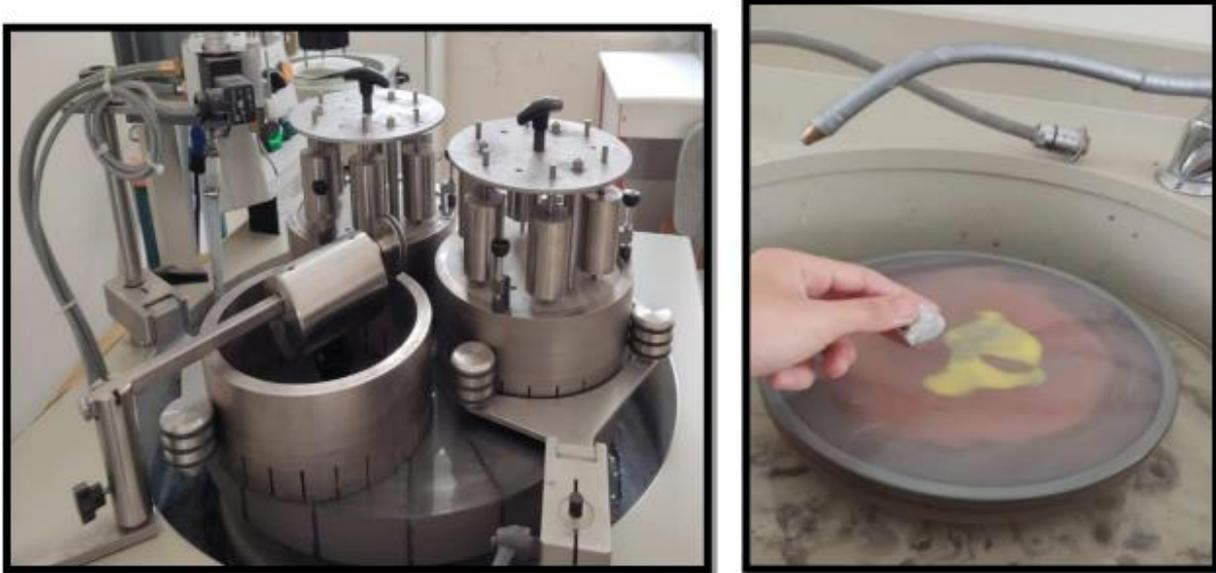
**Figure 2: Le rodage appelé aussi "le prépolissage"**
