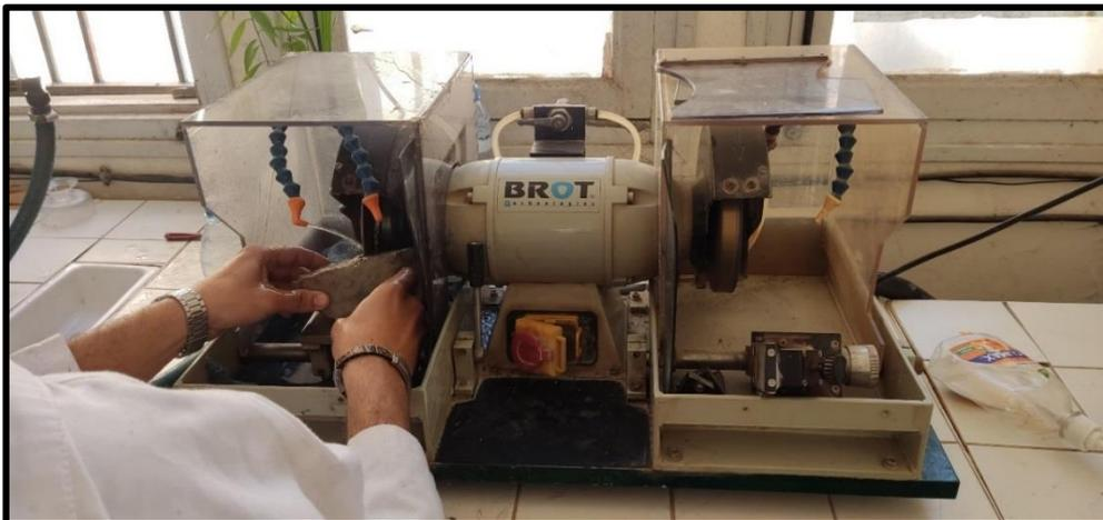
Figure 1: Une scie diamantée
