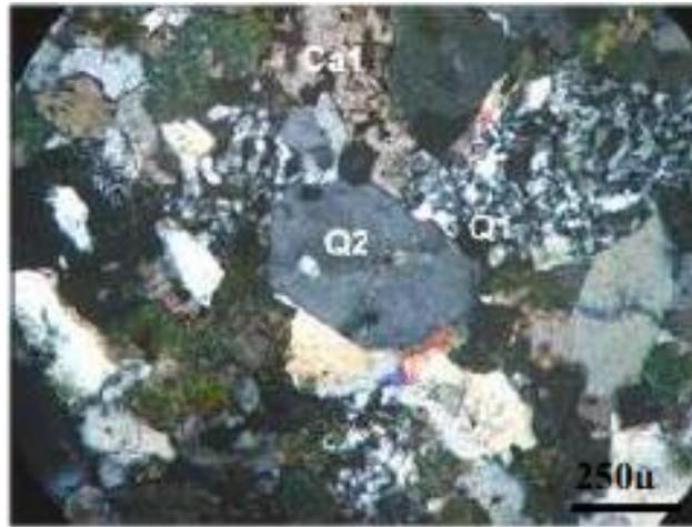
**Figure 31: lame mince montrant les deux générations de quartz (Sami.L 2011) LPA,
