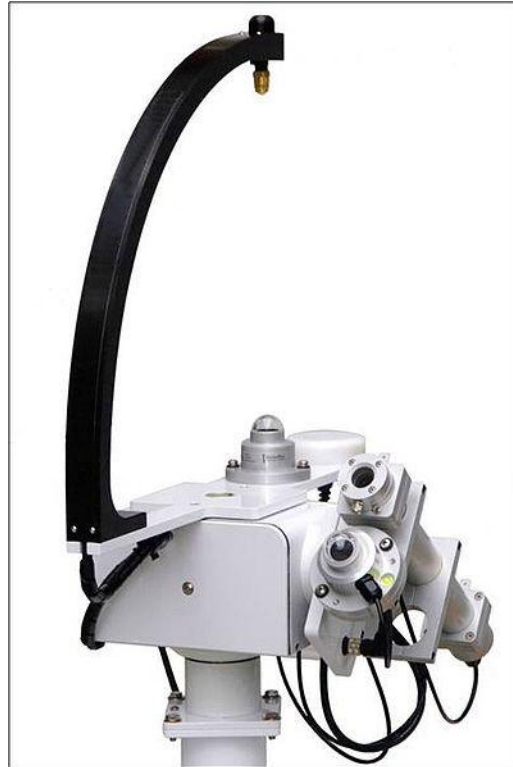
Figure 1.5. Exemple de pyrhéliomètre équipé d'un système de suivi pour maintenir l'instrument pointé vers le soleil.
