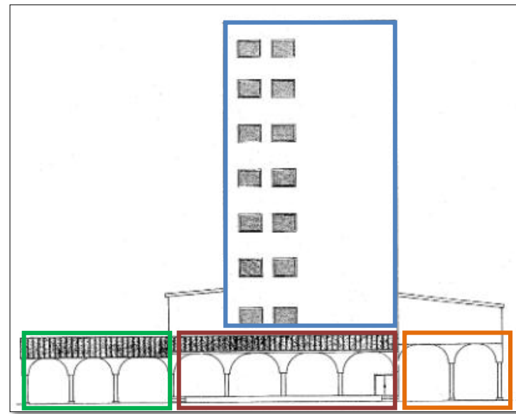
Figure 22: La façade de l'est qui montre la zone d'expédition, les fosses de réception ainsi que le bâtiment des machines, source: Jica, 1990, traité par auteurs.
