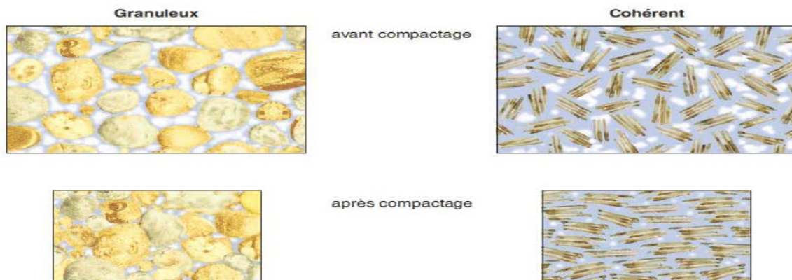
Figure IV.1 : Compactage des sols.
