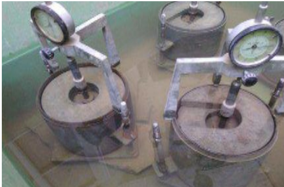
Figure IV.19 : Essai CBR après immersion, imbibition et gonflement.
