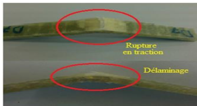
Figure V. 30 : Eprouvettes rompues en flexion trois points.
