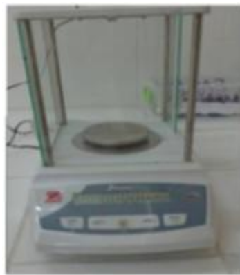
Figure V.11 : Balance de précision 10^{-4} g.
