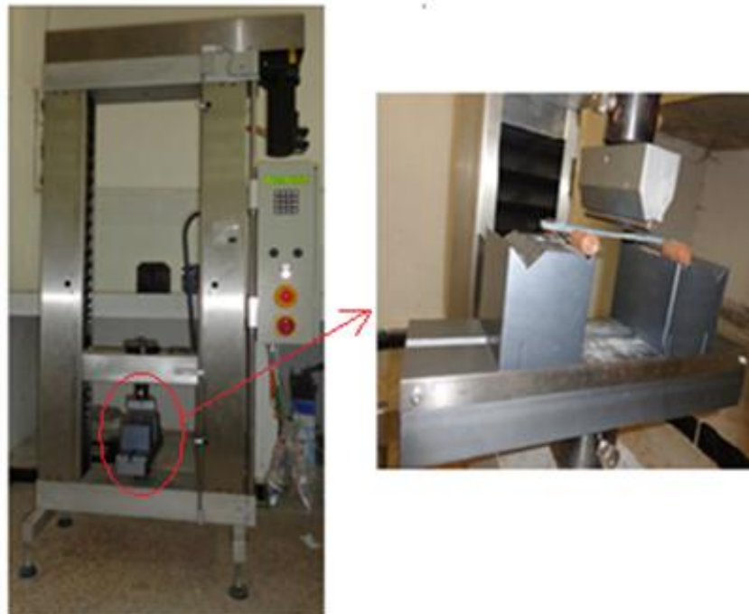
Figure V.17 : Machine et dispositif d'essai de flexion trois points.
