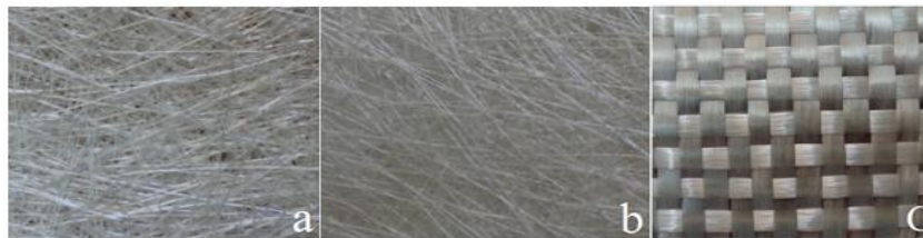
Figure V.2 : Les différents renforts utilisés ; a) Mat 300g/m 2 ; b) Mat 450g/m 2 ; c) Taffetas 800g/m 2
