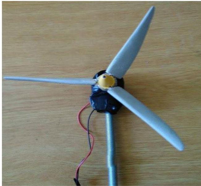
Figure IV.12 : notre éolienne à axe horizontal.
