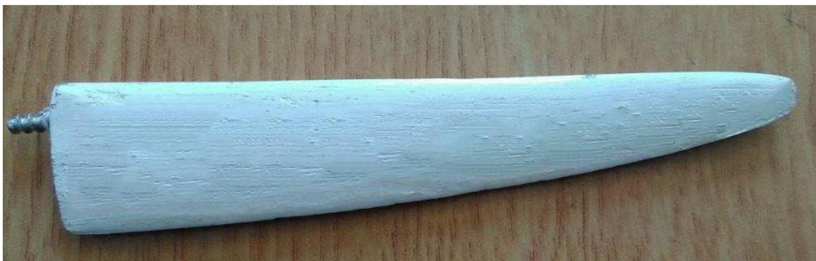
Figure IV.13 : la pale non vrillée utilisée pour l'éolienne à axe horizontal.
