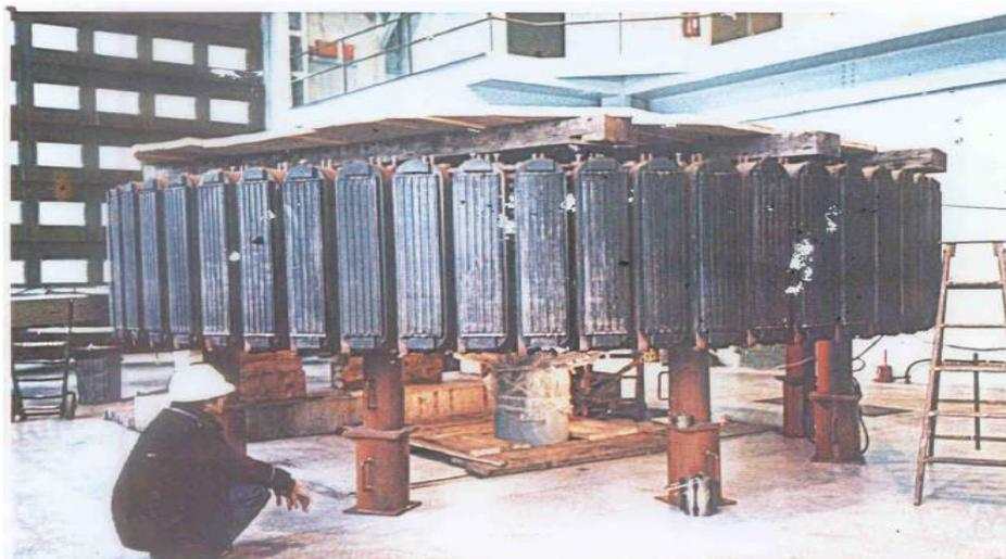
Figure III.2 : Rotor d'un générateur de central hydraulique
