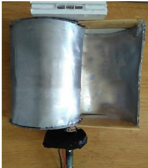
Figure IV.15 : éolienne à axe vertical.
