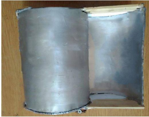
Figure IV.16 : la pale utilisée pour l'éolienne à axe vertical.
