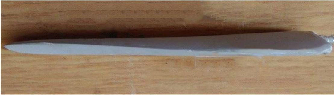
Figure IV.14 : la pale vrillée utilisée pour l'éolienne à axe horizontal.
