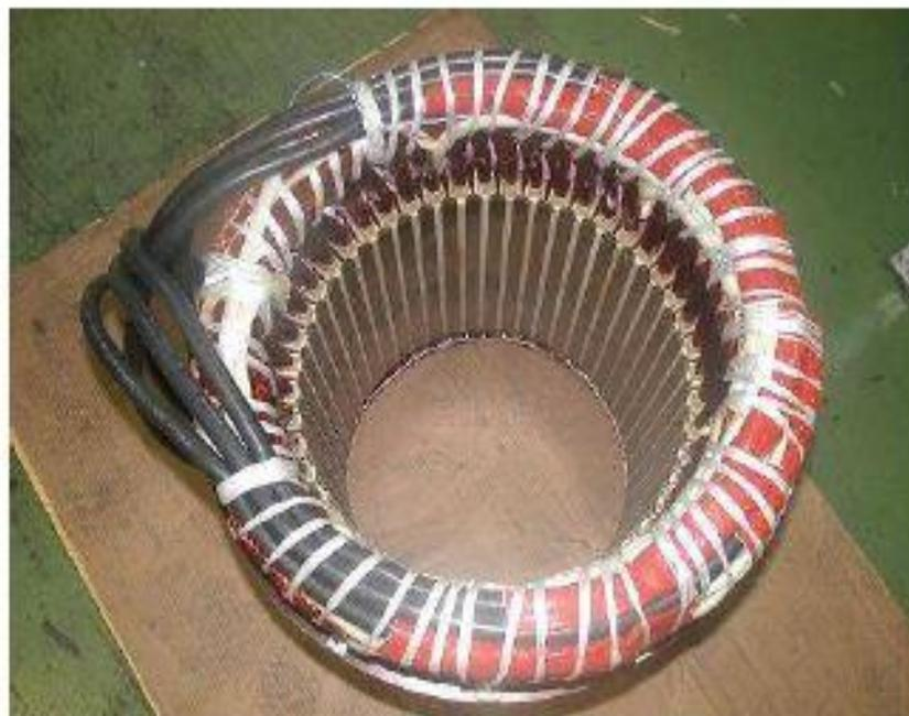
Figure III.11 : Bobinage reparti.
