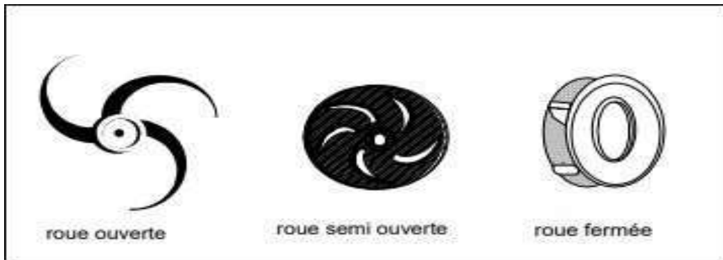
Figure V-3 : forme de l'aube (roue) des pompes centrifuges.
