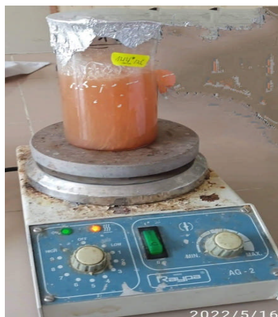
Figure 10 : Concentration du jus de dattes sur une plaque chauffante.
