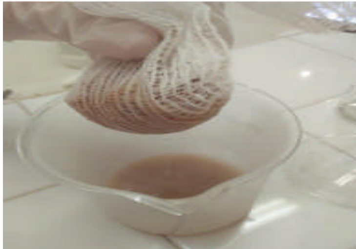
Figure 9 : Récupération d'extrait aqueux de dattes par filtration
