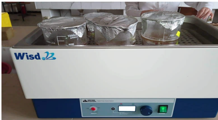
Figure 8 : Traitement thermique du mélange eau- morceaux de dattes au niveau du bain-marie.
