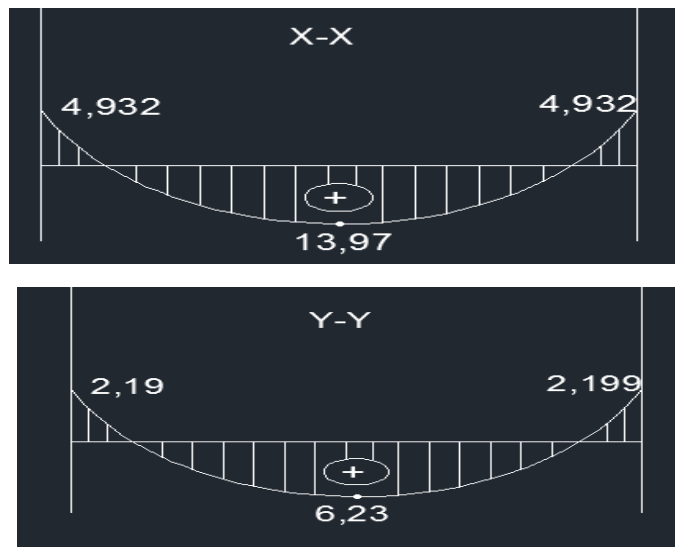
Figure III-21: Les moments aux appuis et en travée dans les deux sens à l'ELU.
