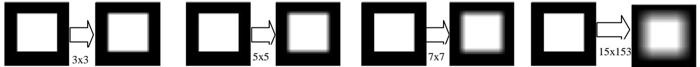
**Figure 3.3:** Exemple montrant le changement de flou par l'augmentation du filtre
