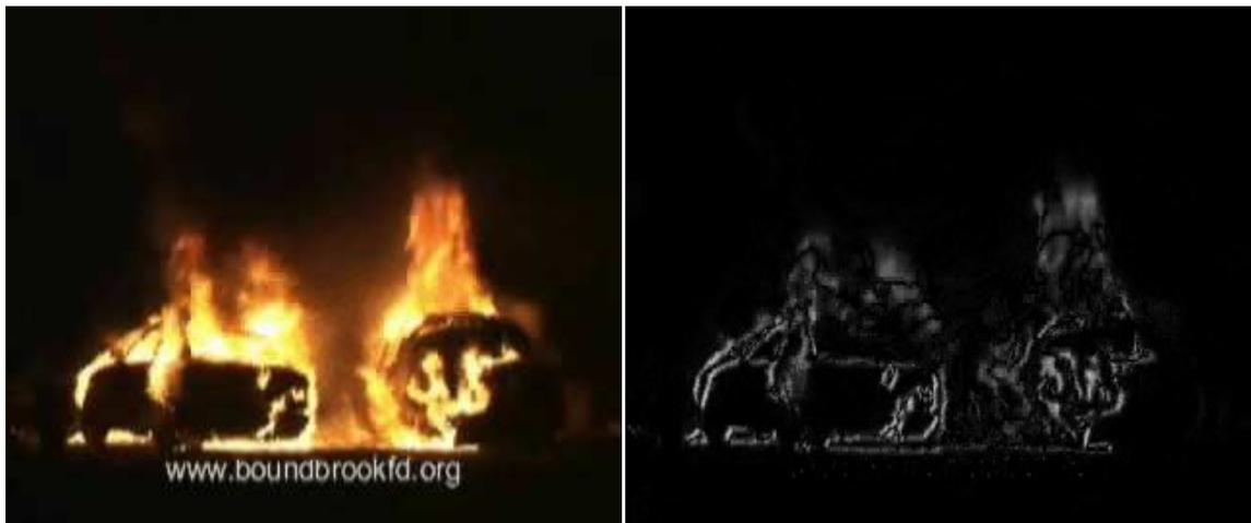
**Figure 1.1 :** Détection de mouvement avec la soustraction de frame
