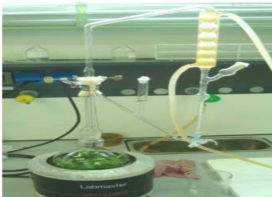
Figure 6 : Dispositif d'hydro distillation de type Clevenger
