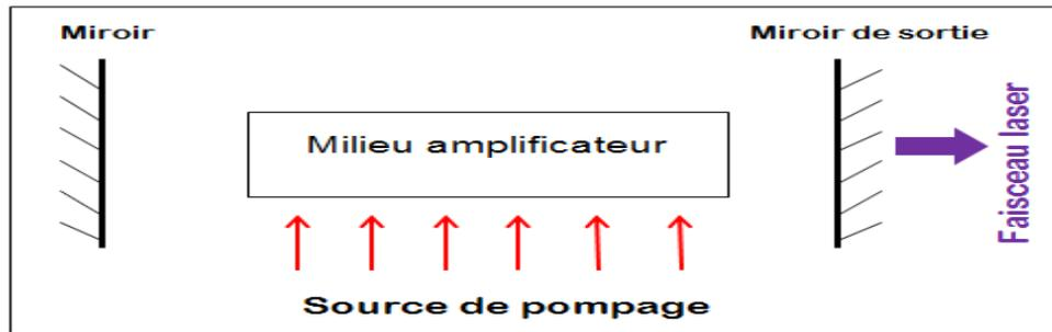
Figure I.2 : Principe de fonctionnement d'un laser.
