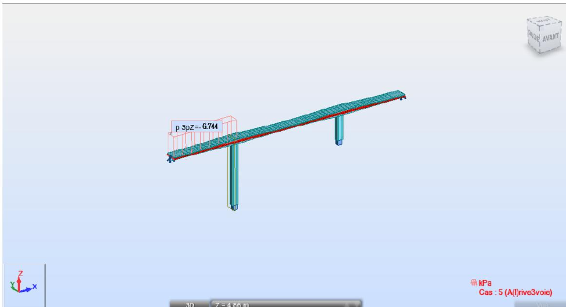
*Figure VV.4 : Modélisation sous surcharge A(L) de rive trois voies chargées.*
