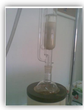
Figure 04 : Extraction de la poudre de la mélisse par soxhlet (original)
