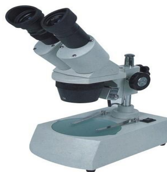
Figure 14 : Identification de la Macrofaune à l'aide d'une loupe binoculaire avec éclairage
