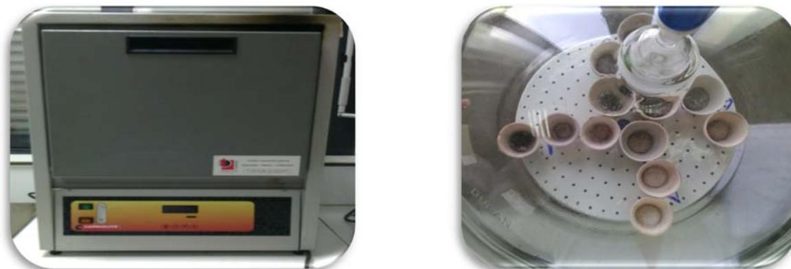
**Fig.19:** Echantillons après incinération dans le four à moufle (Originale, 2018)
