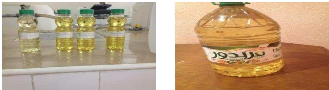
Figure 6 : Variation de la couleur des échantillons d'huile « Fridor » en fonction des conditions de stockage.
