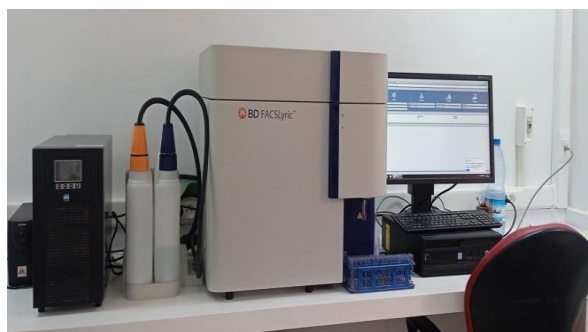
Figure 26 : Photographie d'un appareil de Cytométrie en flux BD FACS Lyric.
