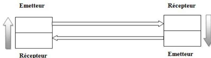
**Figure II.12 :** liaison bidirectionnelle.
