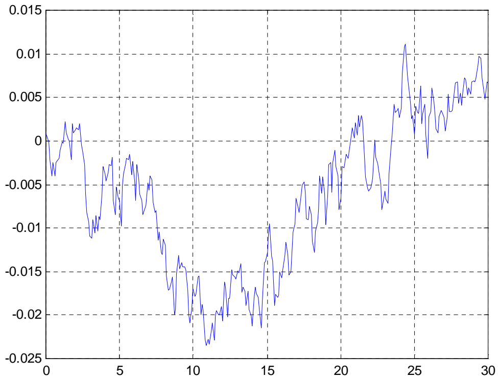
Figure III.54 : l'erreur de vitesse estimée. X_0 = (0 \ 0)^T , bruit de position=2m, bruit d'accélération=0.02m/s 2
