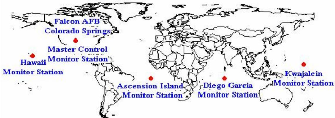
**Figure 1.7:** le segment de contrôle.
