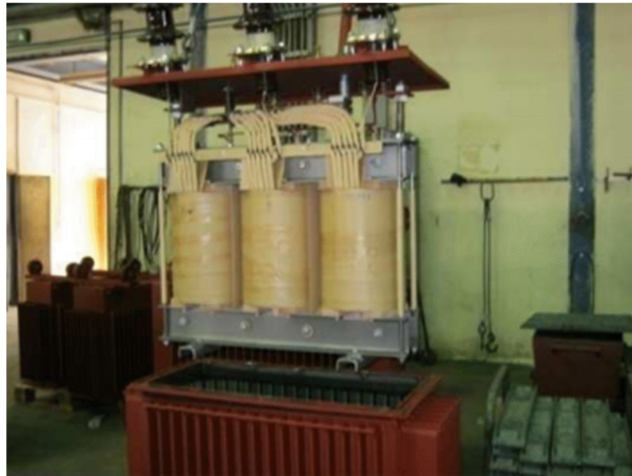
Figure II.8. Encuvage des parties active du transformateur.
