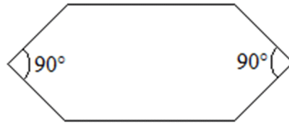
Figure II.6 : Découpe de la colonne centrale du circuit magnétique.
