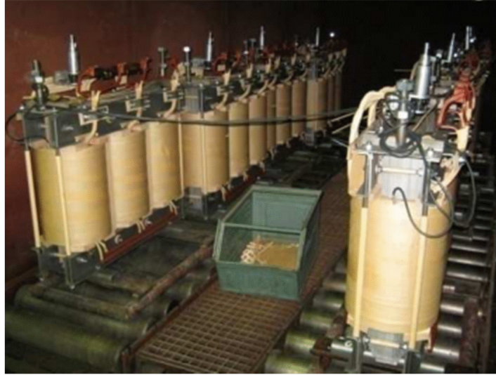
Figure II.7. Séchage des parties active du transformateur.
