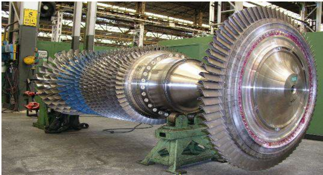
Fig1.7 : turbine de détente HP
