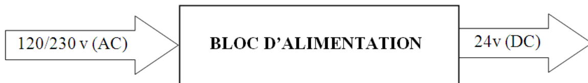
Figure II.2.1 : Alimentation d'un API [9]
