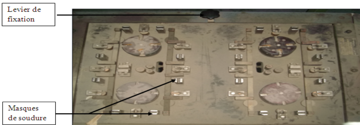
Figure I.2.1 : Poste de positionnement
