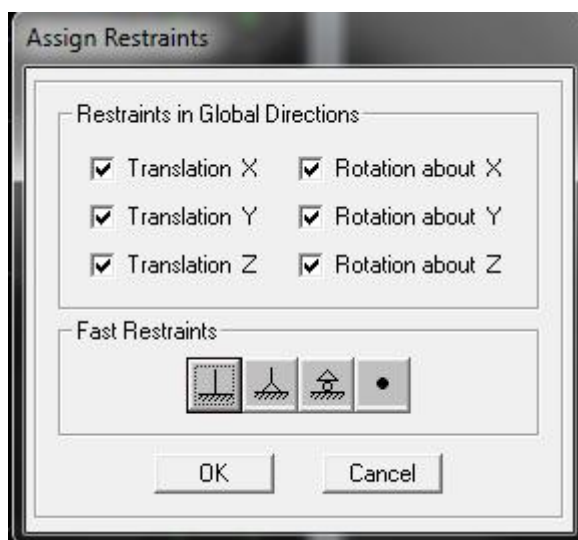
Figure IV.15 : Choix du système de liaison
