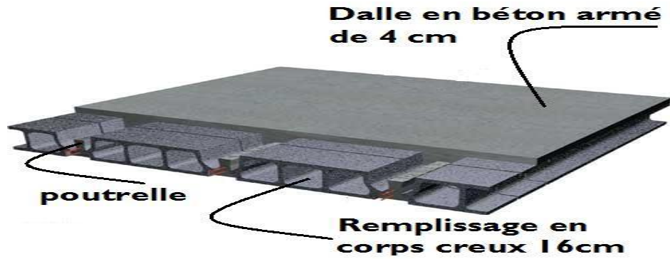
Figure III.3 : Coupe verticale du plancher corps creux
