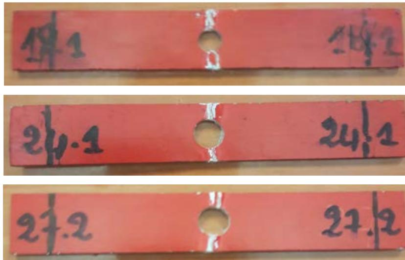
Figure III.7 : éprouvettes avec trous (4, 6 et 8 mm)
