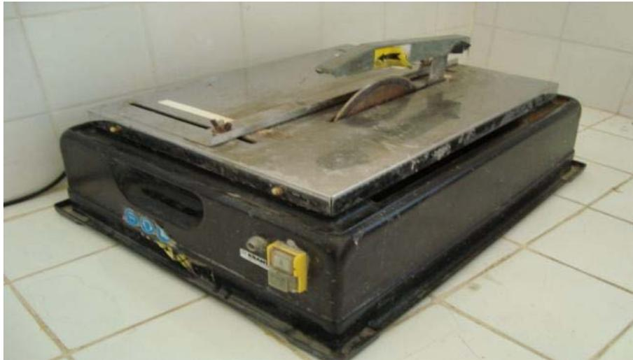
Figure III.5 : Scie à disque diamanté
