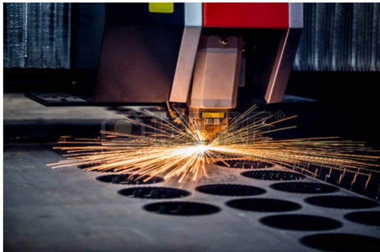
Figure II.3 : Perçage par laser
