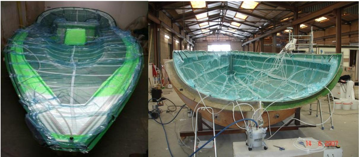
Figure I.13 : Principe du moulage sous vide
