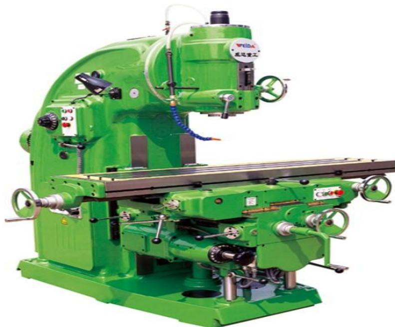
Figure III.9: fraiseuse verticale semi-automatique
