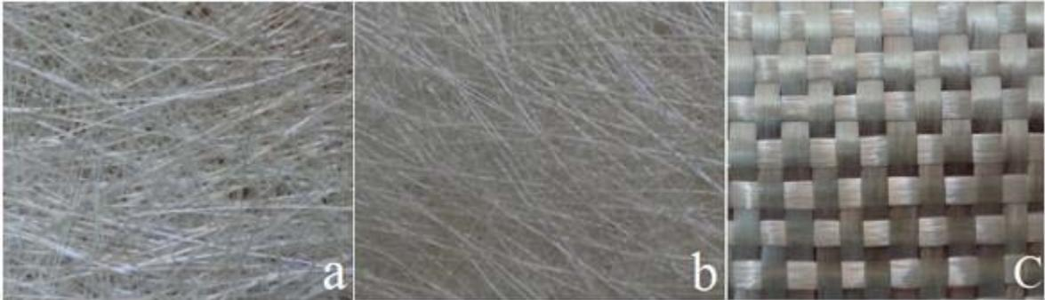
Figure III.3 : Les différents renforts utilisés ; a) Mat 300g/m2 ; b) Mat 450g/m2 c) Taffetas 800g/m2
