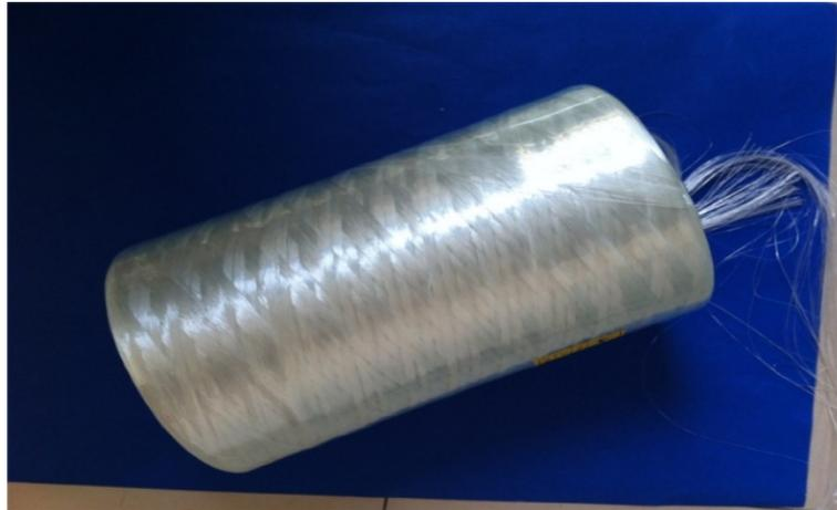
Figure I.2 : Bobine de fibre de verre
