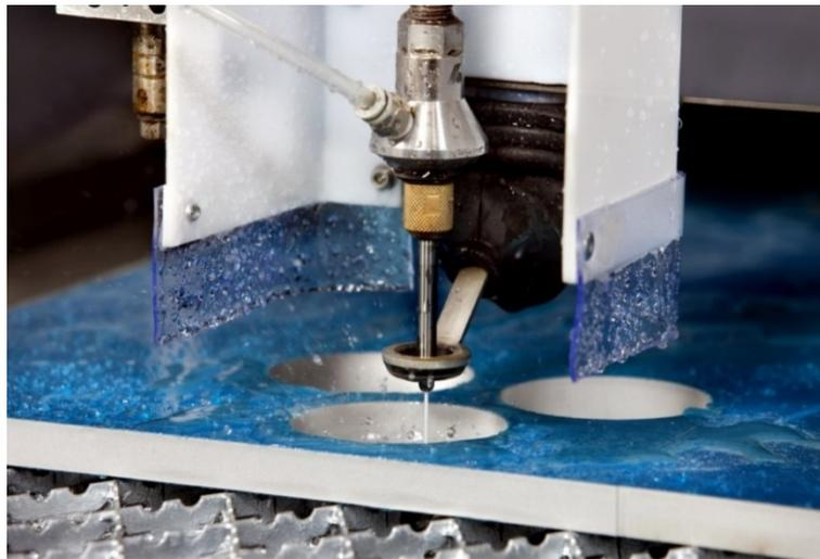
Figure II.2 : Perçage par jet d'eau à haute pression
