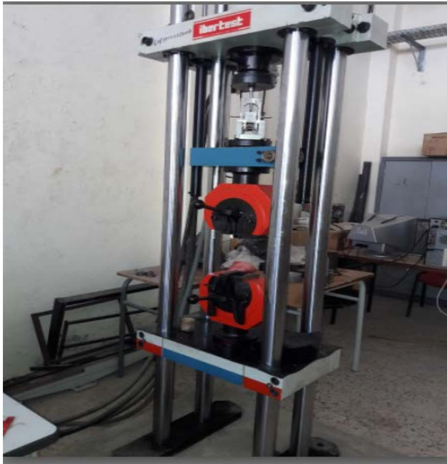
Figure III.11 : machine de flexion type Z50
