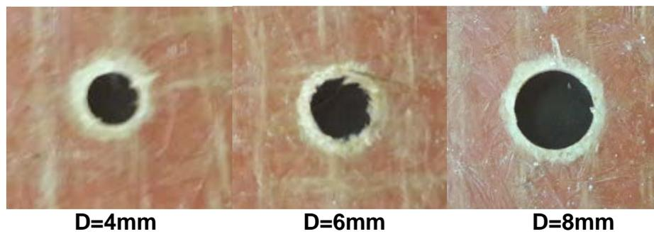
Figure II.22 : perçage à 180 tr/min et vitesse d'avance de 250mm/min avec foret
