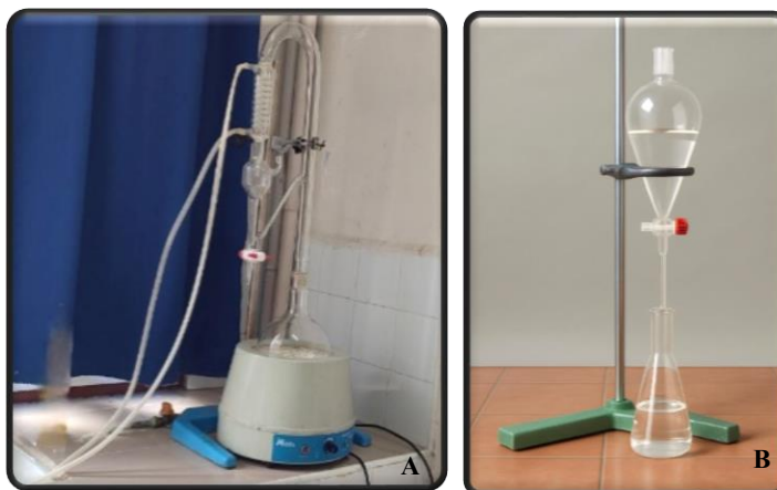
Fig. 29 : Dispositif du processus d'hydrodistillation : hydrodistillateur (A) et ampoule à décanter (B) (Originelle, 2025).
