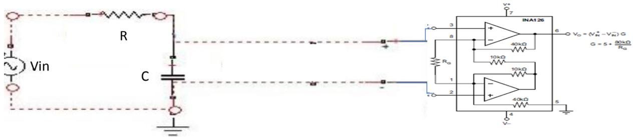
Figure II.4 schéma électrique du filtre passe bas
