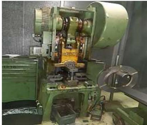
**Figure III-1 : Presse mécanique.**
