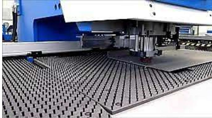
**Figure II-8 : Poinçonnage.**
