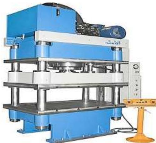
Figure III-10 : Presses à colonne.
