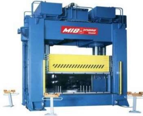
Figure III-6 : Presse à triple effets.
