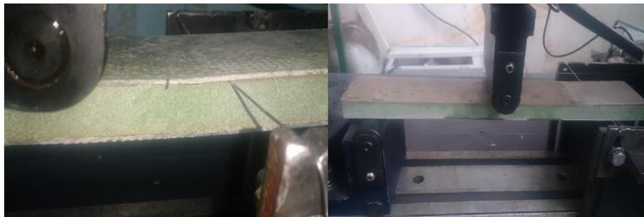
**Figure II.16** : Les essais de flexion 3 points des travaux de **H. M Bahabadi et al [56]**
