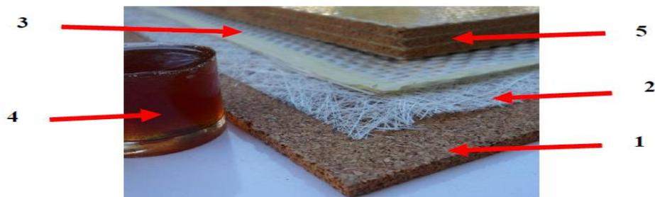
**Figure II.12** : Les matériaux utilisés par **Hami** pour le sandwich [55]
