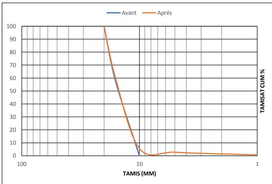
Figure III.9 : Courbes granulométriques des échantillons testés avant et après pilonnage.
